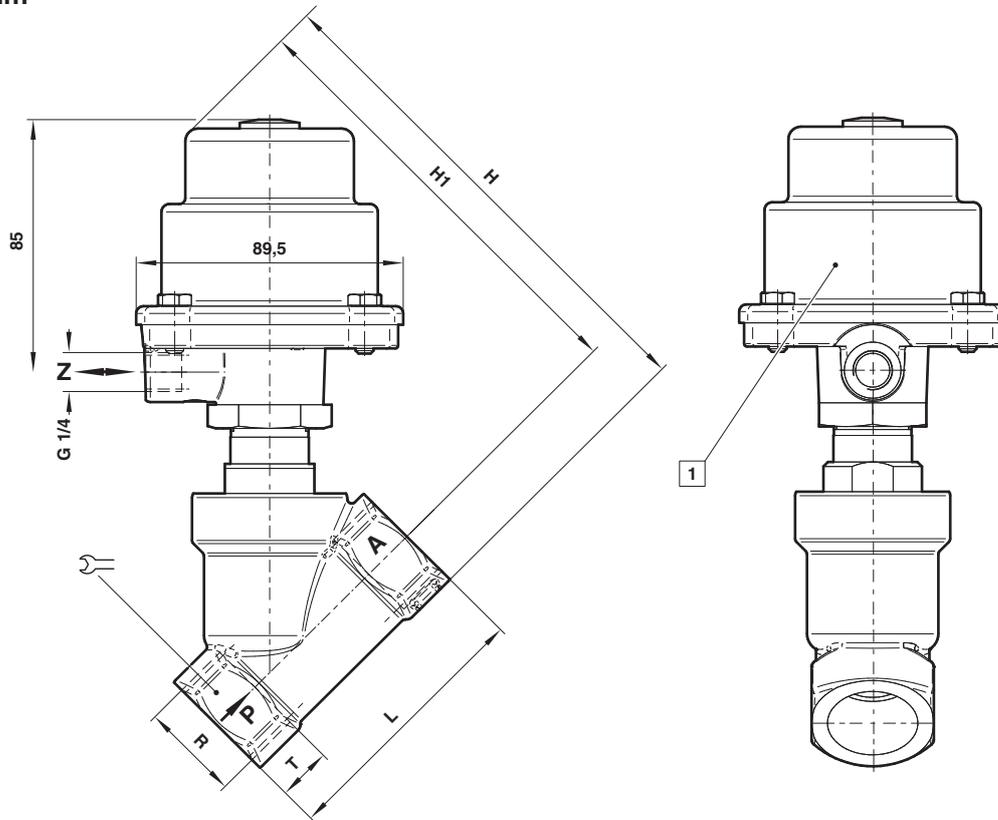
1 Antrieb um 360° stufenlos drehbar
