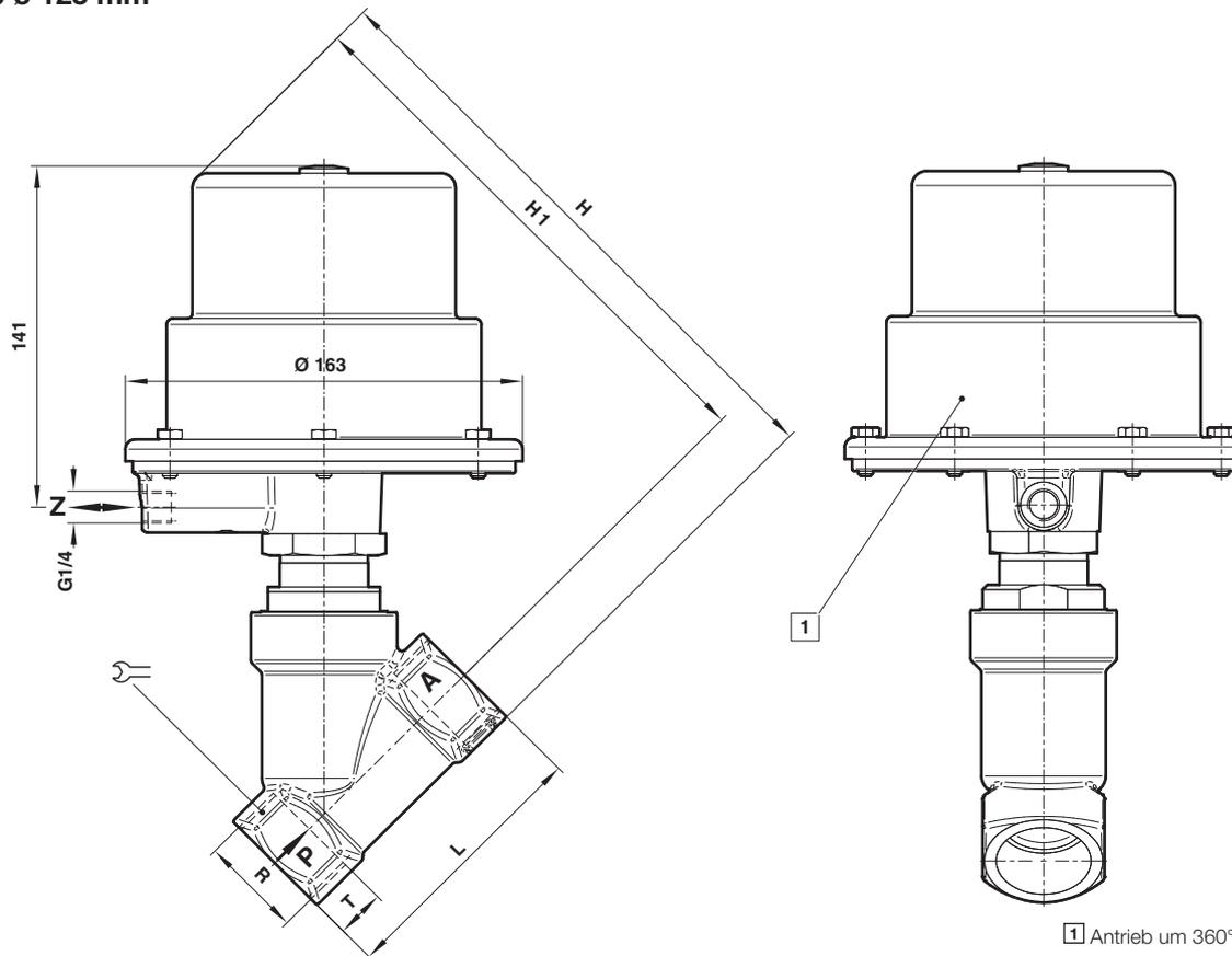
1 Antrieb um 360° stufenlos drehbar
