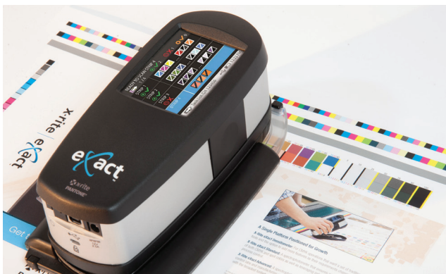
Messung von langen und kurzen Streifen (bis zu 112 cm) mit eXact Scan
